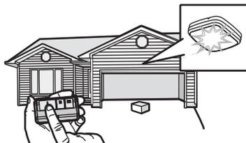
L'ouvre-porte de garage ne se ferme pas à l'aide d'une télécommande si le témoin DEL d'un des deux capteurs d'inversion est éteint (ce qui avertit que le détecteur est mal aligné ou obstrué).
